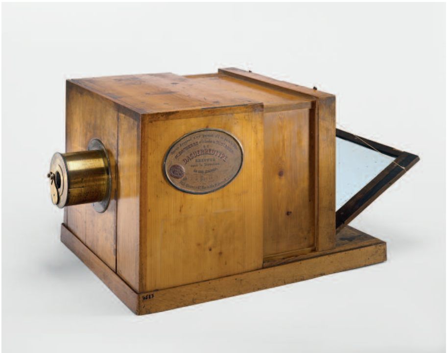
Die erste Kamera nach Daguerre (1839) mit geöffnetem Spiegel.
