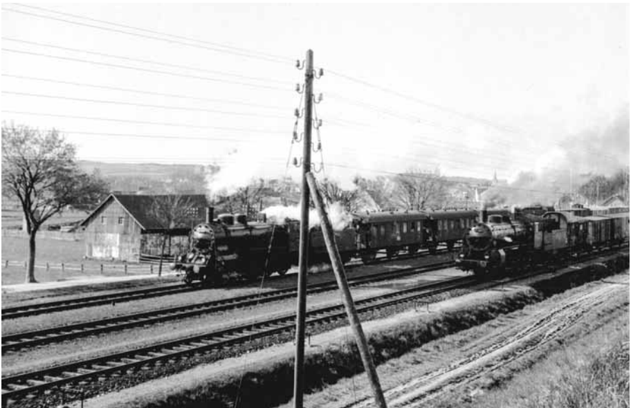
Zwei Dampfloks, links ein bayerischer Personenzug der Baureihe 38, rechts ein 57er Güterzug mit fünf Achsen und vier Zylindern, auf dem Weg nach München [ca. 1935]
